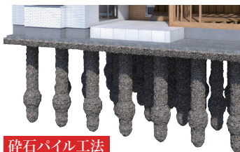
碎石パイル工法
