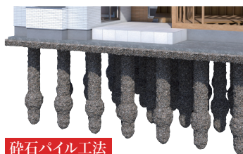
砕石パイル工法
