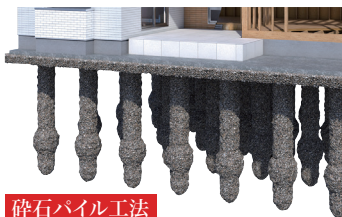
碎石パイル工法
